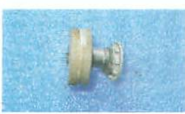
摩耗したアルミサッシの戸車
