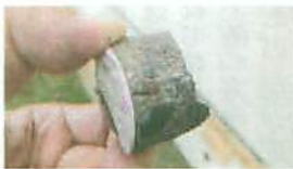
コンクリートから採った試験体(中性化調査)
